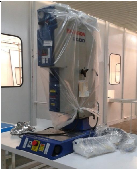
Equipo para la soldadura por ultrasonido de las luminarias
